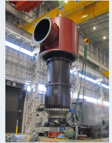
発電所向け取水用ポンプ
