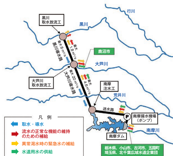
水融通システムの仕組み(提供：水資源機構)
