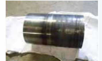
グランドパッキン焼付きによる軸スリーブ損傷事例
