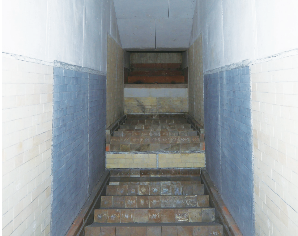
焼却炉の内部。エバラ HPCC21型ストーカを採用している
