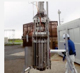
液体水素昇圧ポンプ
