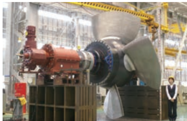
可動羽根軸流チューブラポンプ回転体 (呼称口径4,200mm)
