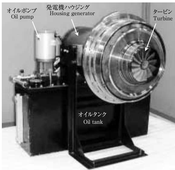
写真1 ガスタービンエンジン Photo 1 Micro-gas-turbine engine
