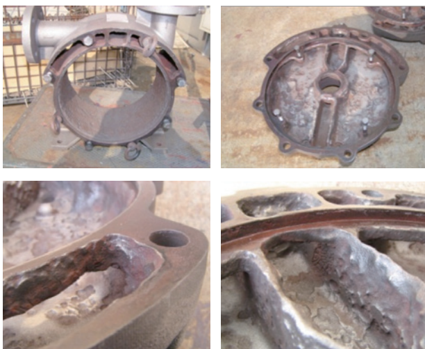
写真3 真空ポンプの腐食状況 Photo 3 Corrosion in vacuum pump
