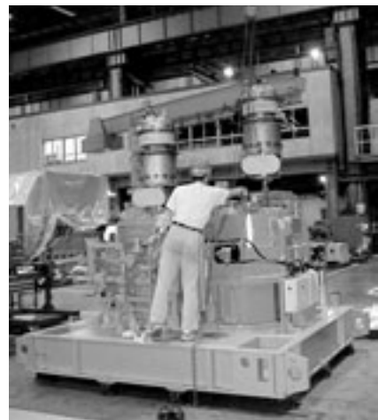
写真24 立形ガスタービン組立中 Photo 24 Assembly of vertical gas turbine
