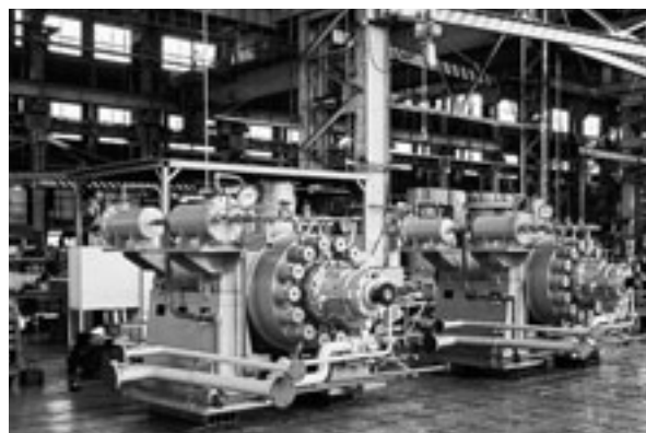
写真2 マレーシア600 MW火力発電所向けBFP Photo 2 BFP for a 600 MW power plant in Malaysia
