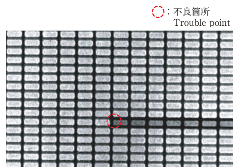
写真2 配線の電位コントラスト像 Photo 2 Voltage contrast image of an interconnect
