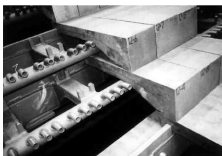
写真2 強制空冷ストーカ Photo 2 Forced air-cooled type stoker
