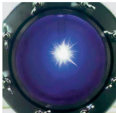
写真1 パルス放電時の発光（水道水中） Photo 1 Discharge channels in tap water
