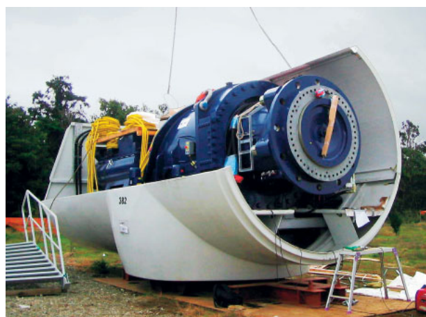
写真2 ナセル Photo 2 Nacelle of EPW1570
