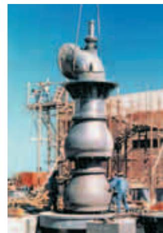
写真2 多段フラッシュ海水淡水化プラント用ブライン循環ポンプ(ニレジスト鋳鉄) Photo 2 Brine recirculation pump for MSF (Multi-Stage Flash) desalination plant (Ni-Resist cast iron)
