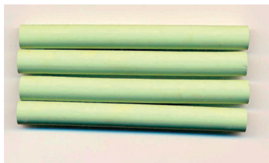
写真1 試作した両端開放基体管 Photo 1 Support tubes of SOHG cells (both-end open type)
