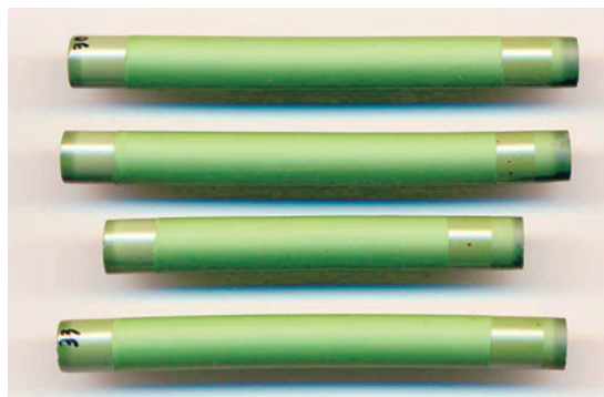
写真3 成膜した両端開放型セル Photo 3 SOHG cells (both-end open type)
