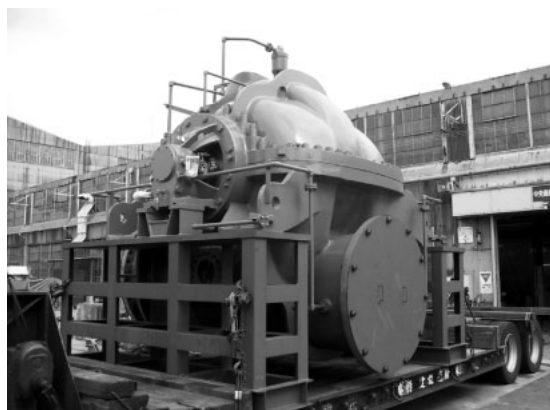
写真8 サウジアラビア石油化学プラント向け横軸冷却水ポンプ Photo 8 Horizontal cooling water pump for petrochemical plant in Saudi Arabia
