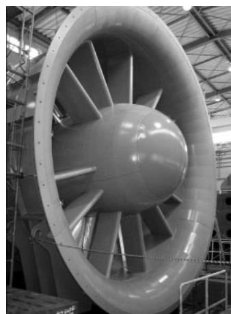
写真15 実車風洞用軸流送風機 (口径5500 mm)
