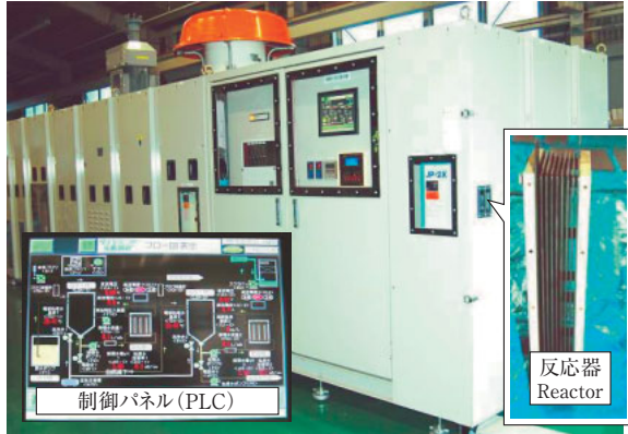
写真2 ダイヤモンド電極を搭載した廃水処理装置 Photo 2 Wastewater treatment system using diamond electrodes
