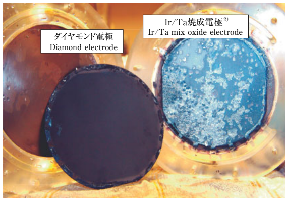
2) Ti基材にIr/Ta混合酸化物を焼成 2) Ir/Ta mix oxide coated on Ti substrate by thermal decomposition
