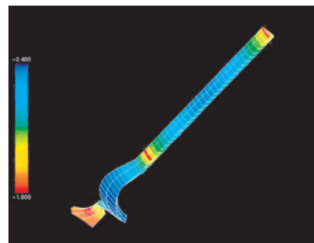
写真3 ポンプ内面電位分布解析結果 31)
