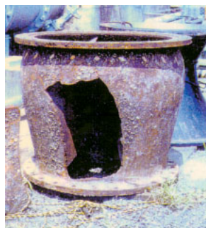
(b) 海水取水ポンプケーシング Seawater intake pump casing, natural seawater
