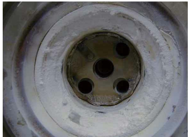
写真5 スクレーパ動作後 Photo 5 After operating the scraper
