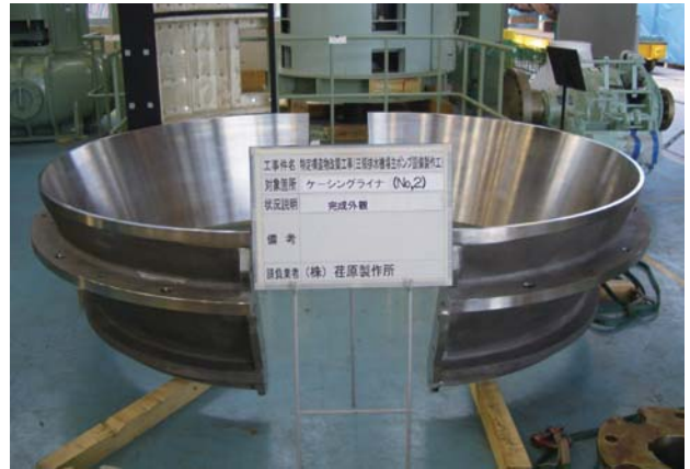
写真3 二つ割構造としたケーシングライナ Photo 3 Casing liner (2-pieces split type)
