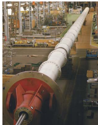
写真2 工場内での組立状況 Photo 2 Pump assembly at the shop
