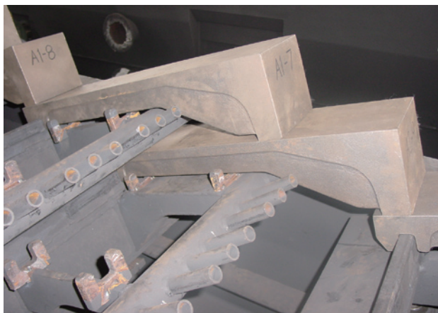
写真3 強制空冷ストーカー Photo 3 Forcible air-cooling type stoker
