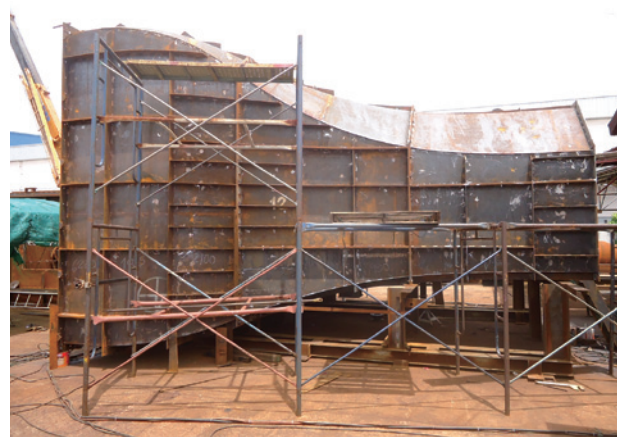
写真1 ダクト組立状況 Photo 1 Shop assembly of wind tunnel ducts
