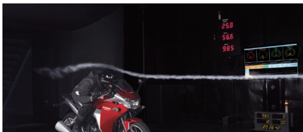
写真6 煙試験状況 Photo 6 Smoke test conditions
